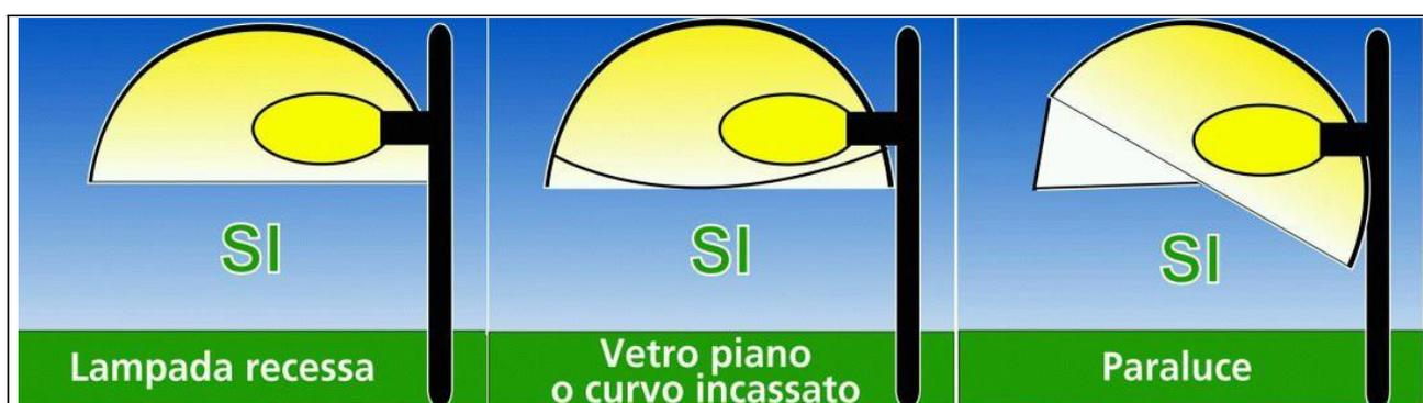
Fig.2 – Apparecchi conformi alla L.r. 17/09.
