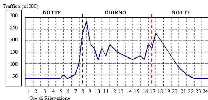
E' evidente che questo discorso è fortemente influenzato da molte variabili, dal tipo di strada e da dove si trova, e pur essendo in parte generalizzabile, è necessaria un'attenta analisi dei flussi di traffico. I sistemi per la riduzione del flusso luminoso devono mostrare soprattutto caratteristiche di flessibilità per poter far fronte a tutte le esigenze non solo astronomiche di alba e tramonto, ma anche a quelle del territorio.
